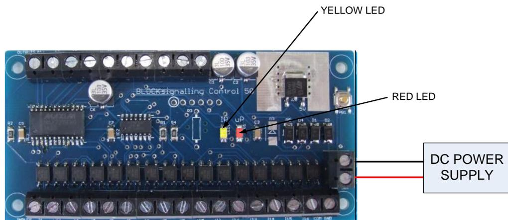
1. CONNECT POWER SUPPLY (BETWEEN 10V AND 25V DC)
