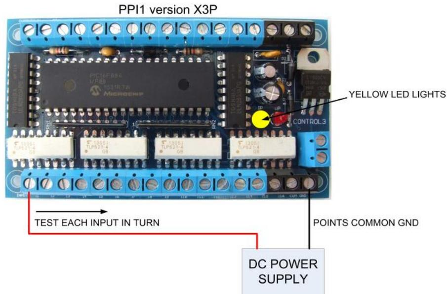
1. CONNECT DC POWER SUPPLY (RECOMMENDED AROUND 12V)
